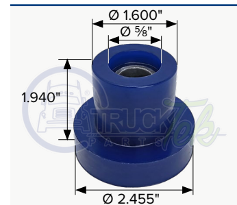
OEM K066-177 Soporte de camarote en poliuretano, tipo T-800
