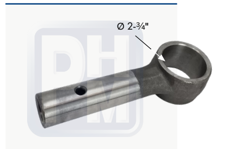
OEM 64473-000 Terminal de tensor para buje de torsión de 2-3/4" acero forjado
